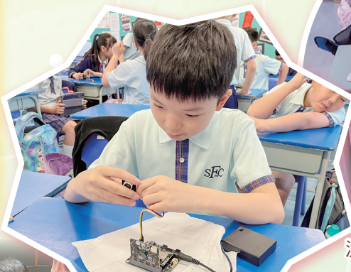
利用microbit和超聲波感應器 製作盲人避障器
